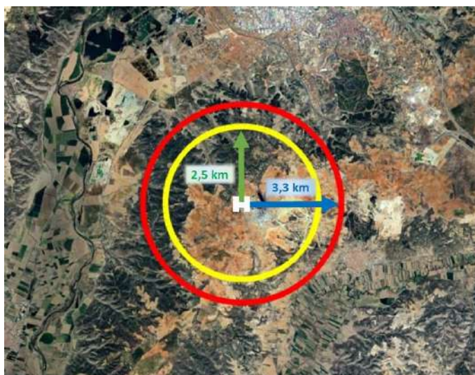
Ilustración 21. Distancias de seguridad en planta. Helipuertos civiles de uso restringido.
