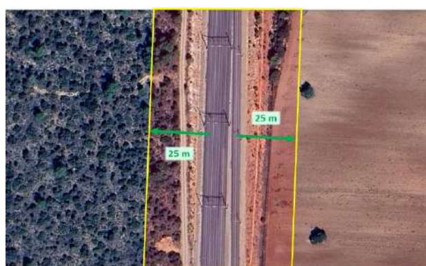
Ilustración 5. Infraestructura lineal ferroviaria - Vista en planta
